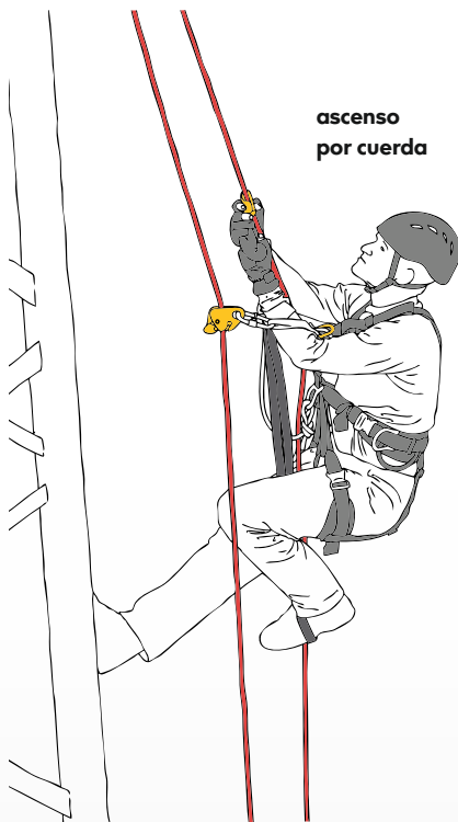
Colocación de los bloqueadores de puño y de pecho.
